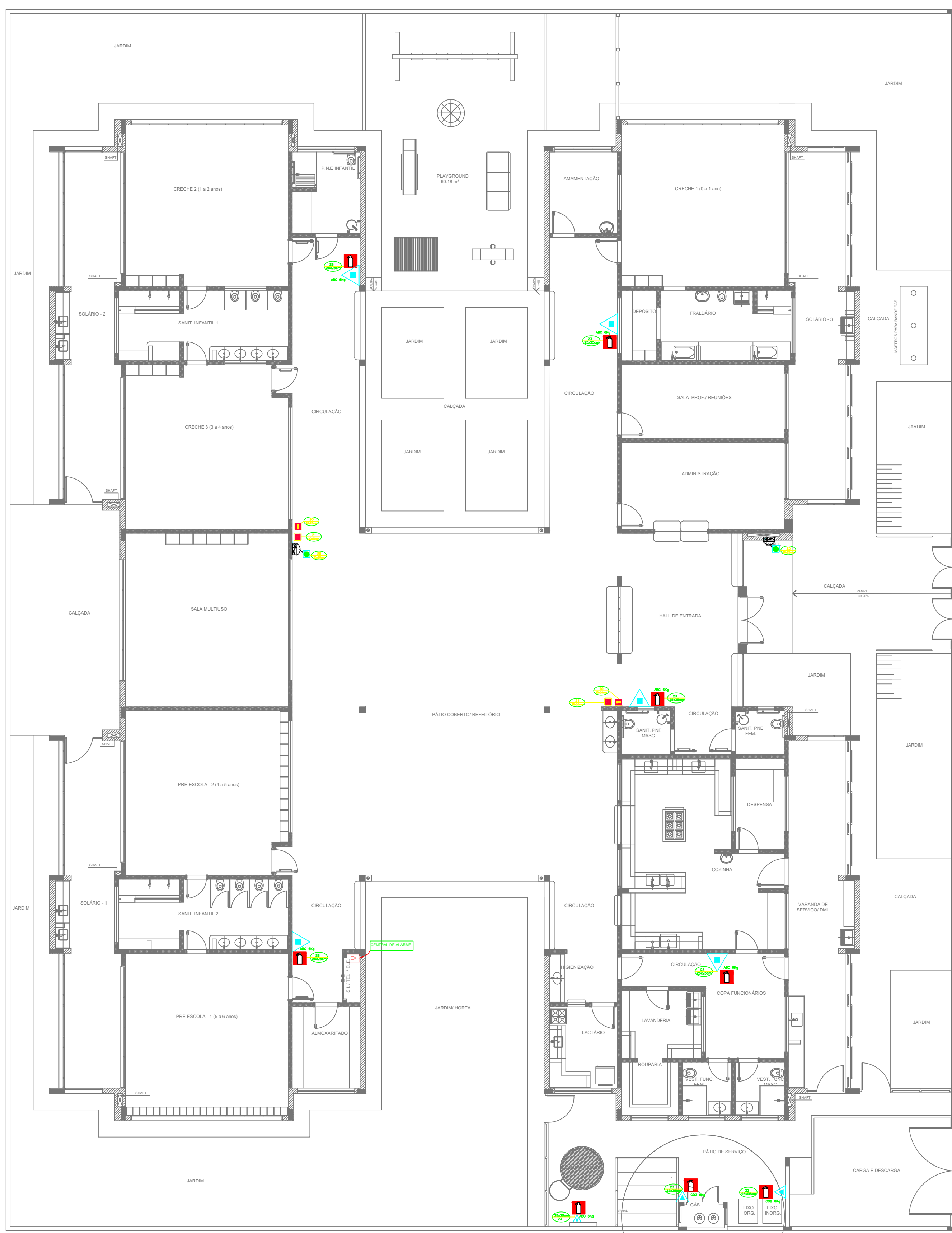
5 PLANTA BAIXA - LOCAÇÃO DOS EXTINTORES ESCALA 1/100
